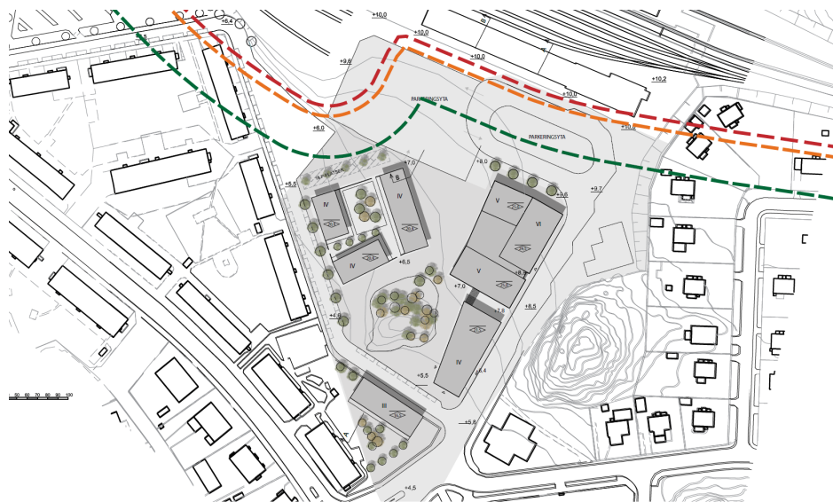
Situationsplan från stadsutvecklingsprogram med riskavstånd, 25, 30 respektive 50 meter till närmsta spårmitt, illustration FOJAB.
