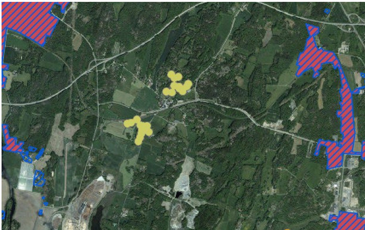
Figur 18: Resultat av täthetsanalys bostadshus, markeringen visar att det är 10–15 hus med max 100 m mellan. Blått/rött raster visar befintligt verksamhetsområde VA. KÄLLA: WSP
